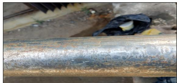
Gambar 15. Penampakan visual anoda setelah perlakuan elektrokinetik
