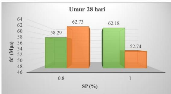
**Gambar 3.** Perbandingan Kuat Tekan Beton Umur 28 Hari.
